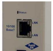
Fig. 6.1 NetGuardian DIN Ethernet Port
