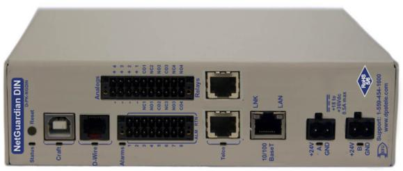
Fig. 5.1 NetGuardian DIN Front Panel
